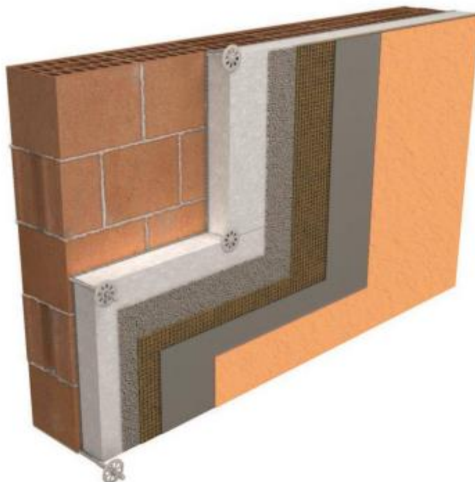
Figura 1. Stratigrafia-tipo sistema a cappotto.
